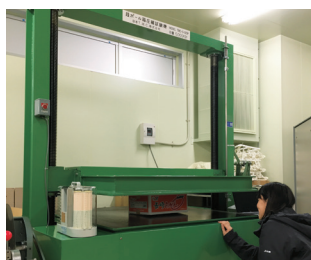
段ボール箱圧縮試験機による品質確認
