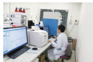
最新型液体クロマトグラフ質量測定装置による残留農薬の測定
